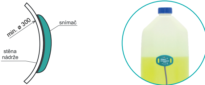
Upevnění FLD-32 pomocí samolepicí vrstvy
